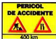
Presemnalizarea unui sector cu circulatie alternanta
